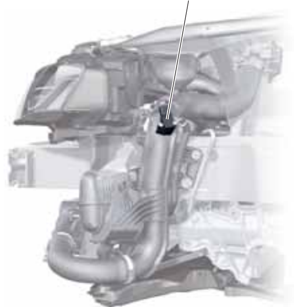
Ladedruckgeber G31/ Ansauglufttemperaturgeber G42
