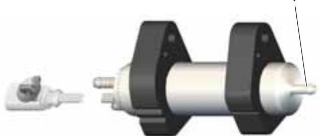
Bomba de combustible adicional V393
