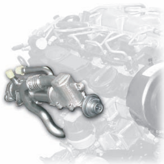
Электродвигатель привода заслонок впускных каналов V157
