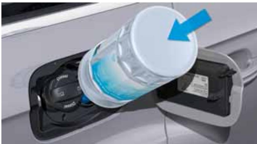
Zum Öffnen das AdBlue®-Nachfüllgebinde drücken und zum Schließen herausziehen.
