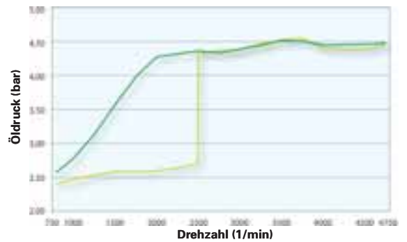
Öldruckverlauf bei 100 °C Öltemperatur
