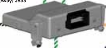
Diagnose-Interface für Datenbus (Gateway) J533
