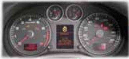
Steuergerät im Schalttafeleinsatz J285
