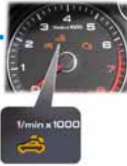
Testigo luminoso de capota en operación K215
