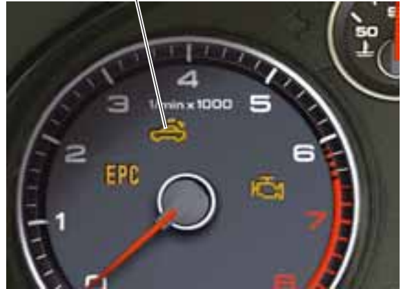
Testigo luminoso de capota en operación K215
