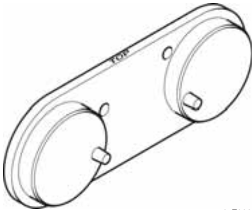
T10171 A Nockenwellenfixierung Arretierung der Nockenwellen, Prüfung und Einstellung der Steuerzeiten
