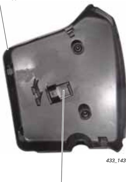
Die Zusatzheckleuchten müssen zum Glühlampenwechsel ausgebaut werden. Die Verschraubung wird wie beim Audi Q7 nach Entfernen der Abdeckungen im Stoßfänger zugänglich.
