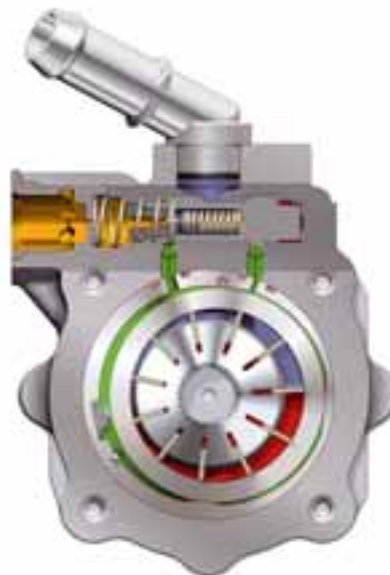
Bomba de la dirección en versión celular de aletas de caudal volumétrico regulado
