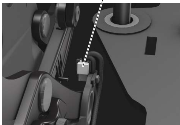
En la figura está cerrada la tapa de la capota (sensor no accionado).
