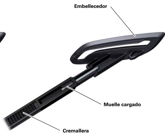
Cremallera con embellecedor estando el muelle cargado
