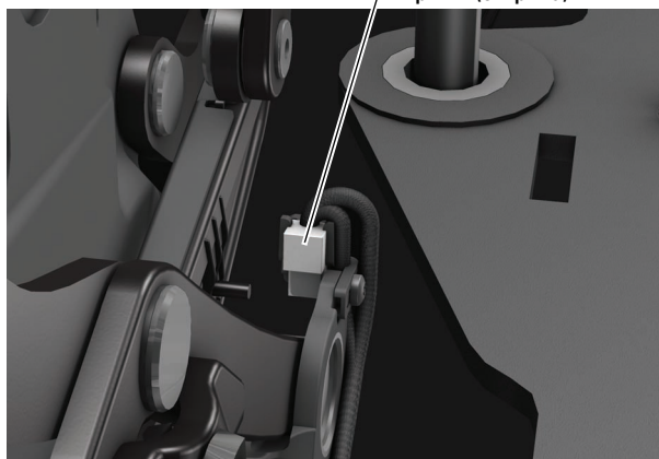
На рисунке показано состояние при закрытой крышке короба (датчик не задействован).
