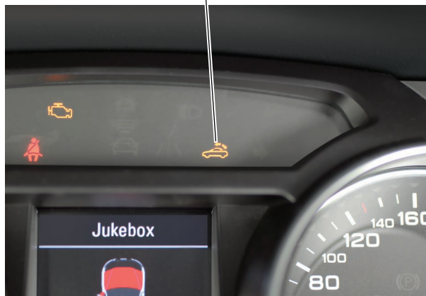
Контрольная лампа привода складной крыши
