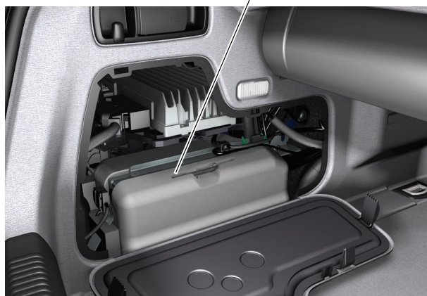
Гидравлический насос привода складной крыши
