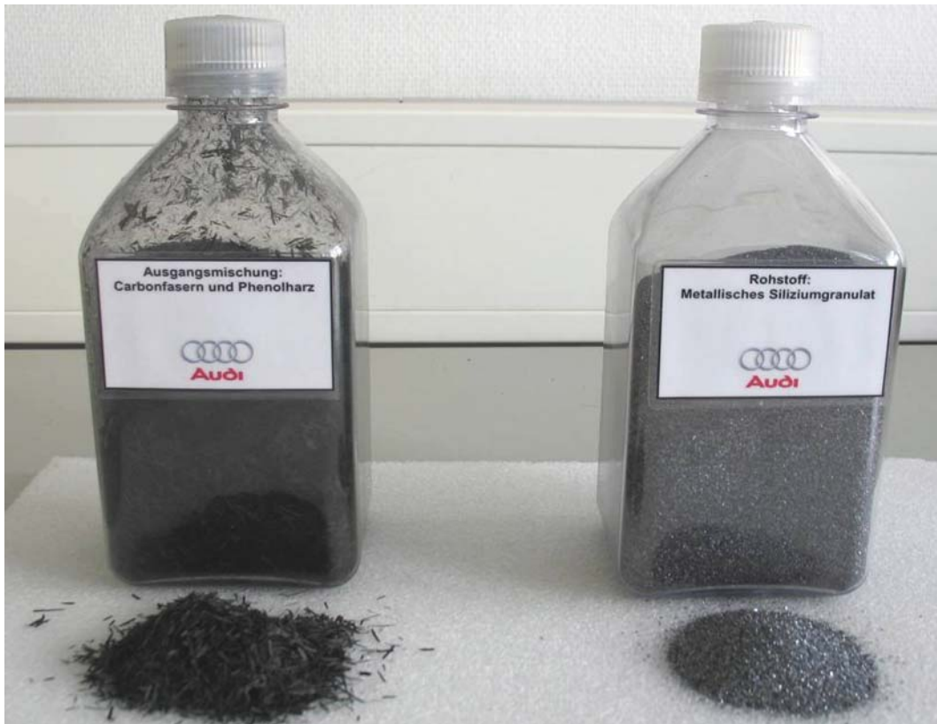
Ausgangsmaterialien: Mischung aus Kohlenstofffasern mit Phenolharz und Siliziumgranulat
