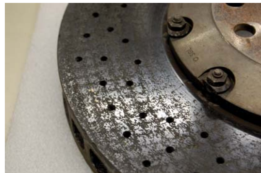
Bremsscheibenoberfläche mit Ausbrand
