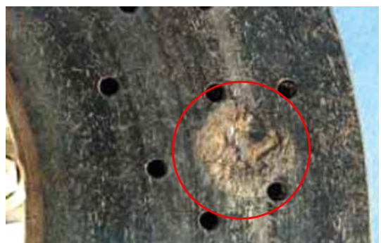
Desprendimiento de la capa de fricción
