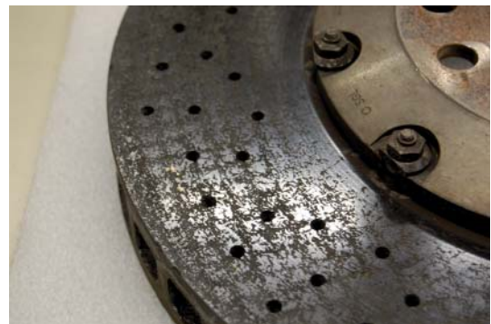
Superficie del disco de freno con quemadura del material
