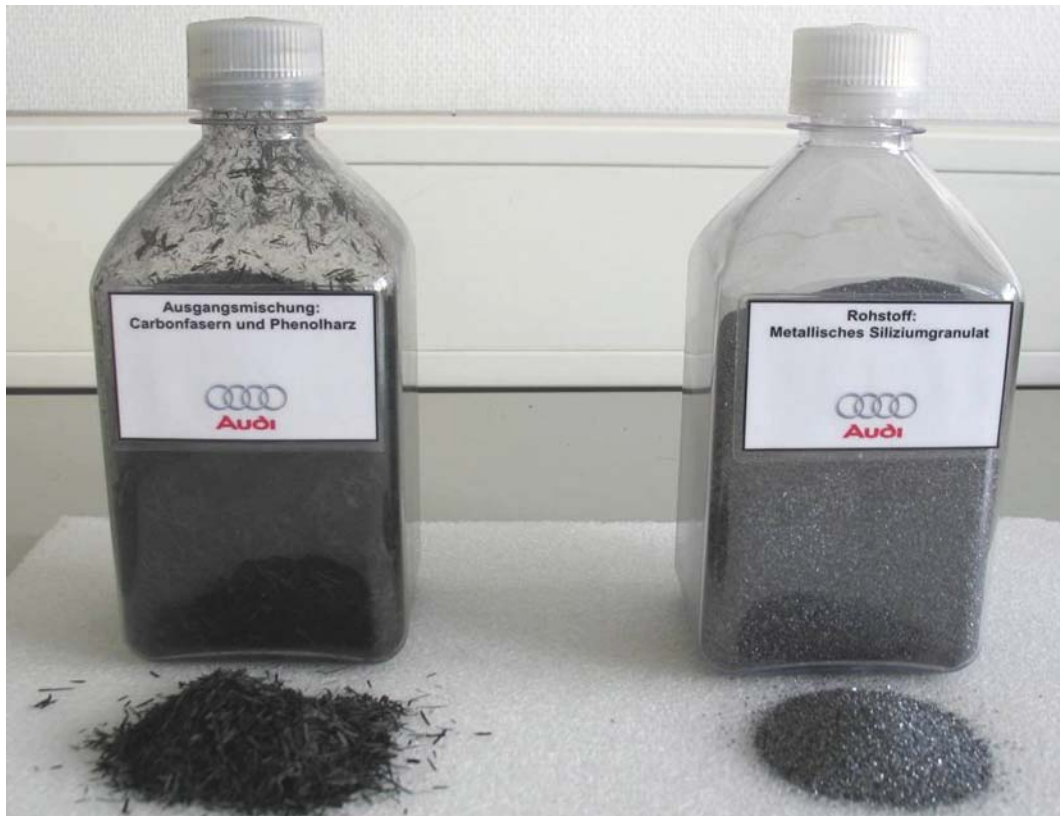
Materias primas: combinación de fibras de carbono con resina fenólica y granulado de silicio
