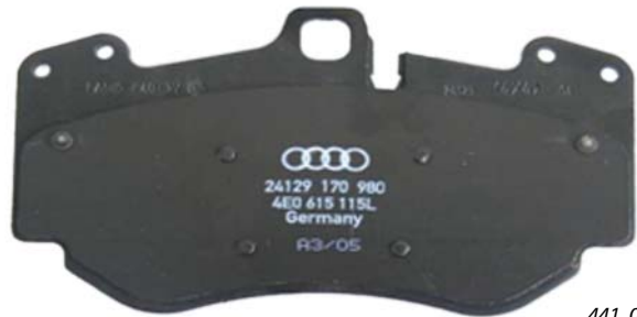
Pastillas orgánicas para el freno cerámico
