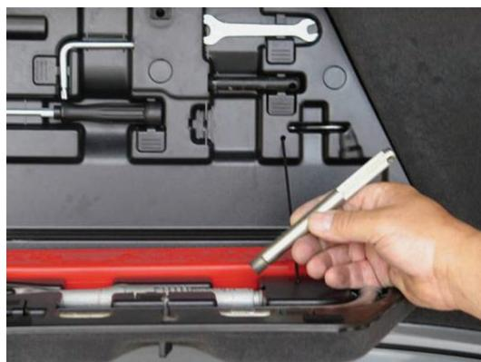
Монтажный стержень из комплекта инструмента, прилагаемого к автомобилю
