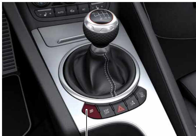
Контрольная лампа спортивной программы K91 в клавише спортивного режима
