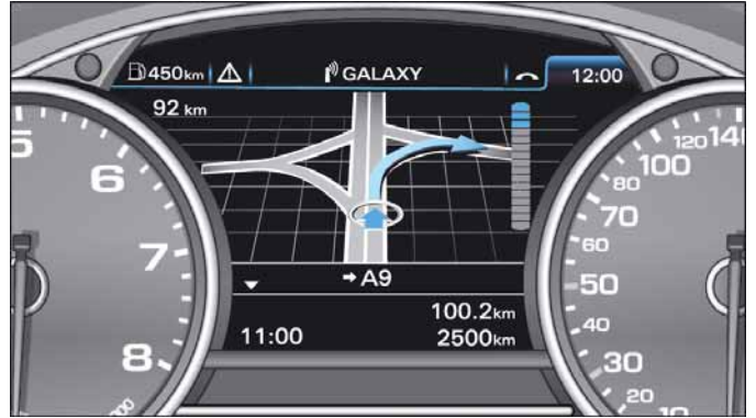
Mitteldisplay im Schalttafeleinsatz
