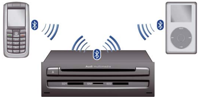
Conexión paralela de Bluetooth entre dos aparatos terminales con J794
