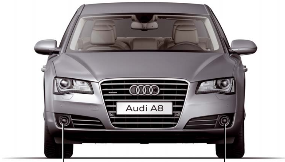
Sensor para ADR derecho G259 y unidad de control de distancia J428
