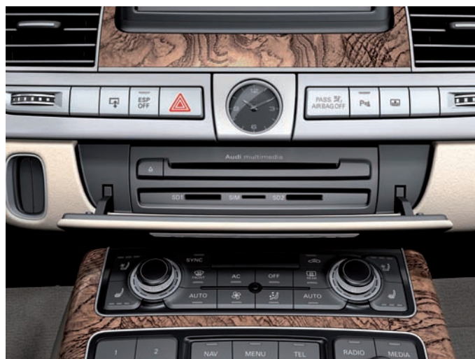
Блок управления электронной информационной системы 1 J794 в центральной консоли
