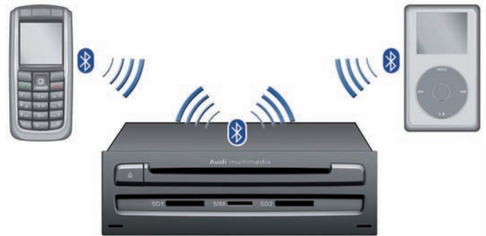
Параллельное подключение двух оконечных устройств к блоку управления J794 по Bluetooth
