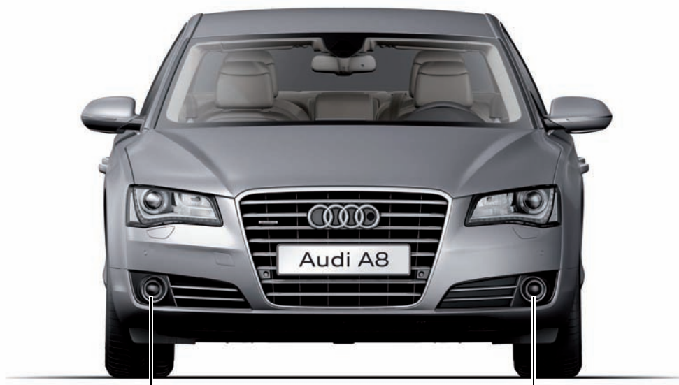
Правый датчик адаптивного круиз-контроля G259 и блок управления адаптивного круиз-контроля J428
