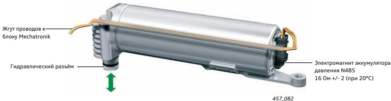
Гидравлический импульсный энергоаккумулятор имеет полезный объем примерно 100 см<sup>3</sup>.
