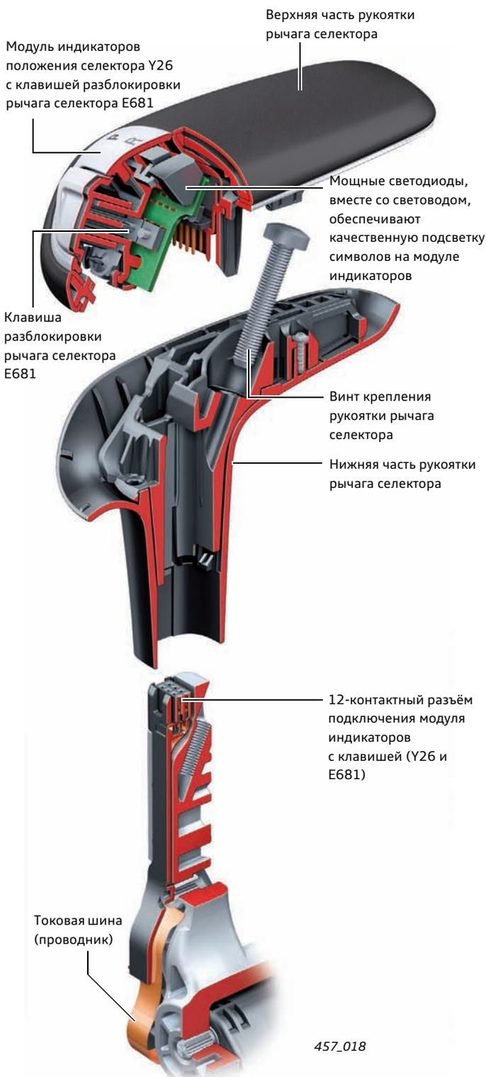
Контроль обоих переключателей осуществляется функцией самодиагностики. При неисправности переключателя выдаётся сообщение о неисправности. До тех пор пока работает хотя бы один переключатель, рычаг селектора можно перемещать.
