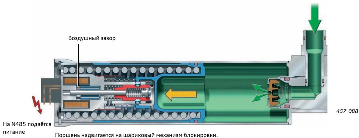
При зарядке поршень смещается влево до упора. При этом якорь удерживающего магнита утапливается в необходимое для блокировки конечное положение и воздушный зазор преодолевается.<sup>1)</sup> Шарики выдвигаются для блокировки, и электромагнит N485 теперь может удерживать якорь электромагнита для того, чтобы поршень оставался заблокированным.
