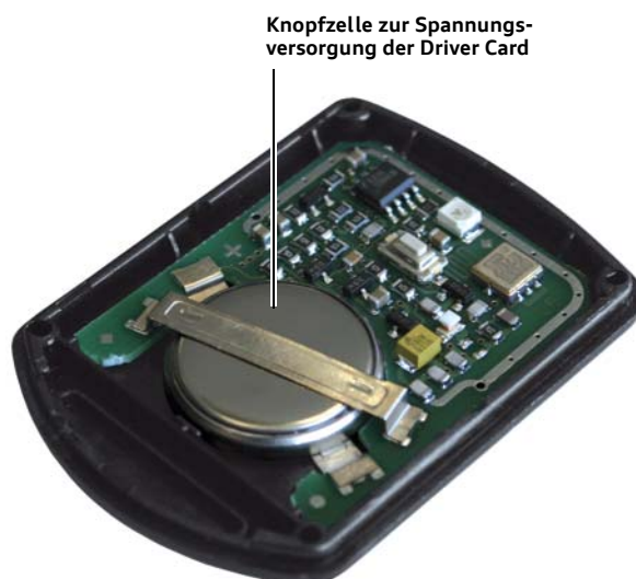
Driver Card im geöffneten Zustand
