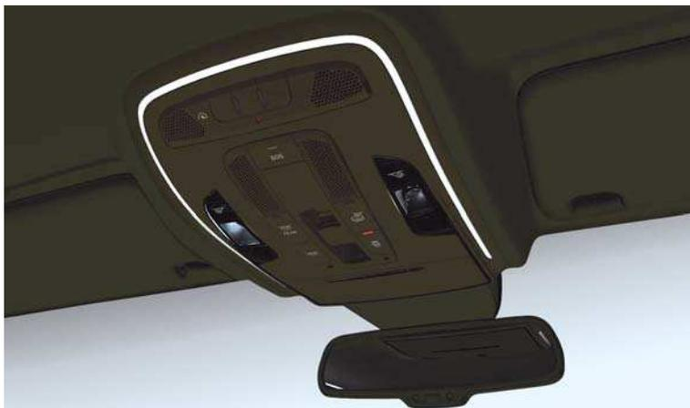
Módulo del techo con conductor óptico
