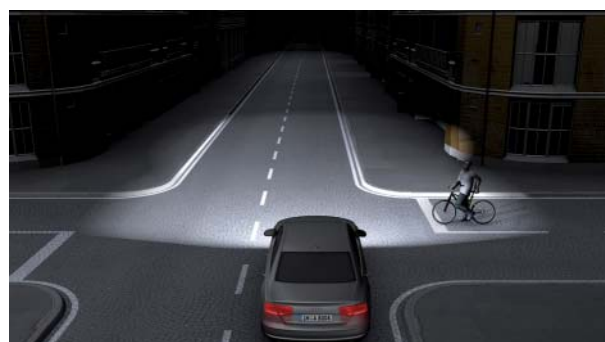
Luz de intersección conectada
