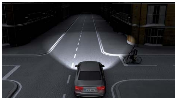
Luz de intersección desconectada
