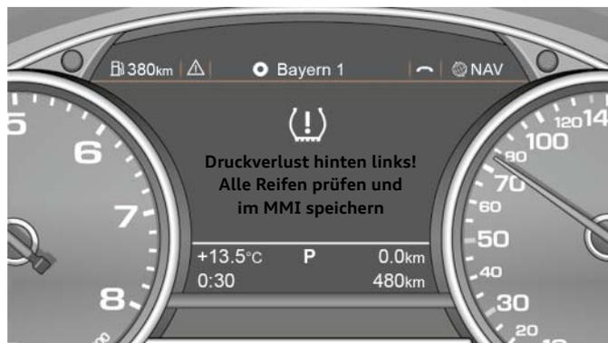
Druckverlustwarnung mit Positionsanzeige
