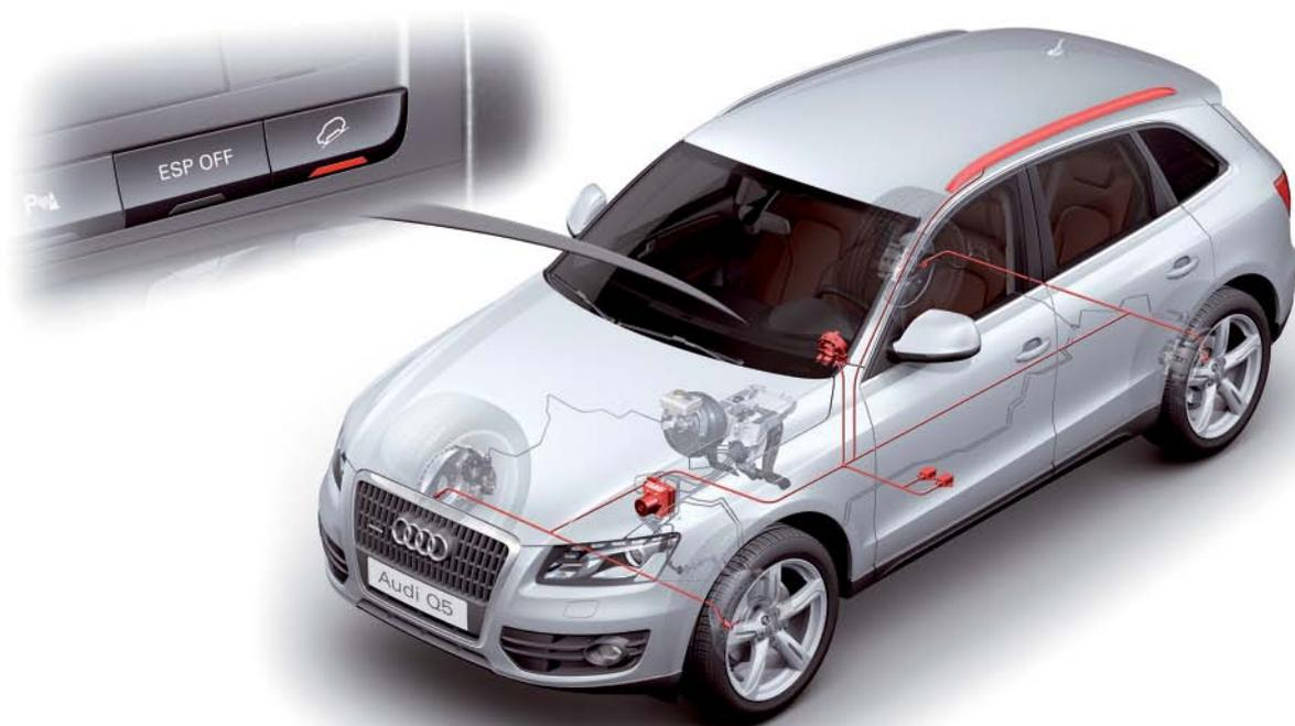
Conmutador para la activación del asistente en descenso del Audi Q5
