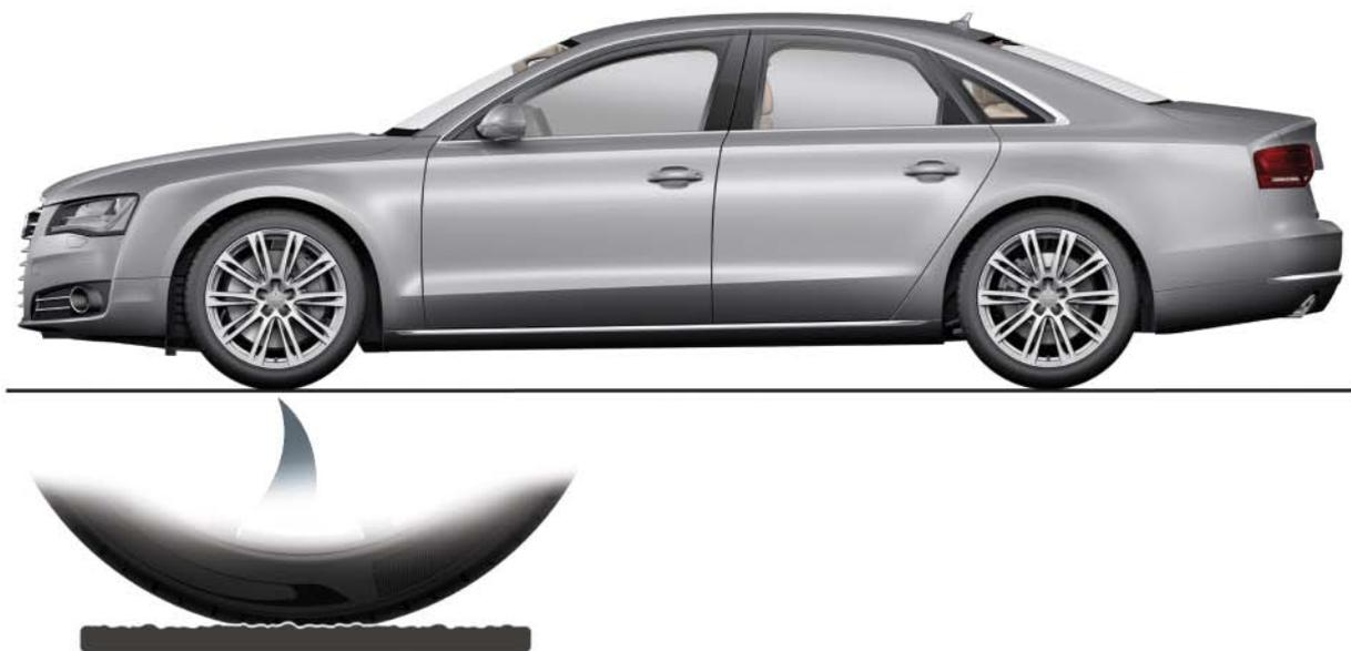
"Dentado engranado" entre neumático y pavimento
