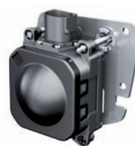
Датчик адаптивного круиз-контроля (правый) G259 и БУ адаптивного круиз-контроля J428
