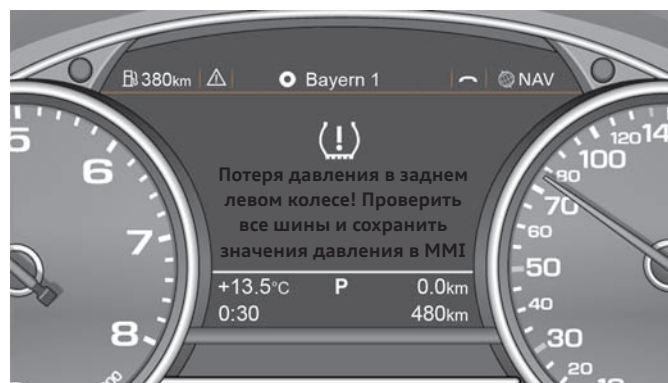
Предупреждение о потере давления с указанием конкретного колеса 475_091
