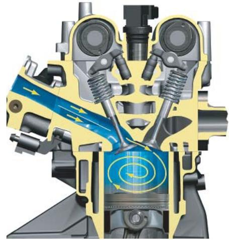
Vierventil-Zylinderkopf ohne Saugrohrklappen
