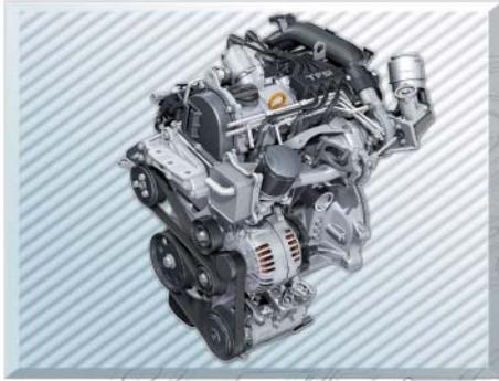
**1,2l-TFSI-Motor (63 kW)**
