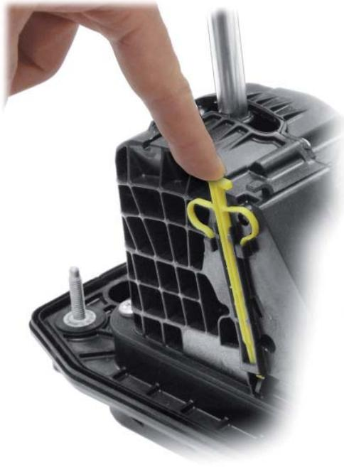
Die Notbetätigung ermöglicht das Schalten aus der Wählhebelstellung P bei Funktionsstörungen der P-Sperre oder bei fehlender Spannungsversorgung.
