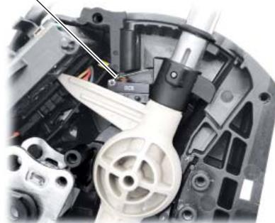
Steuergerät für Wählhebelsensorik J587 mit den Schaltern für tiptronic, die Kommunikation mit der Mechatronik erfolgt mittels CAN-Antrieb
