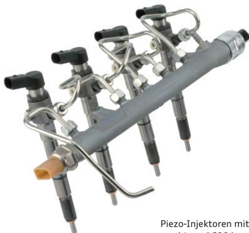
Piezo-Injektoren mit einem Einspritzdruck von bis zu 1600 bar
