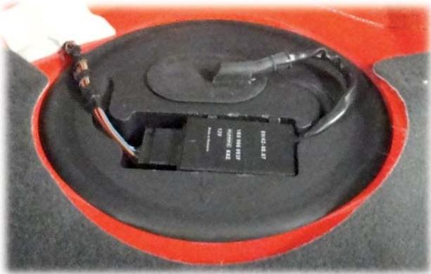
bedarfsgeregeltes Kraftstoffsystem mit Steuergerät für Kraftstoffpumpe
