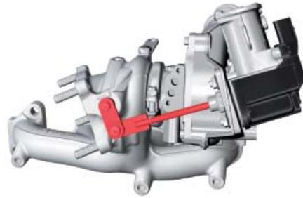
Integralturbolader mit elektrisch angesteuertem Wastegate. Wassergekühlte Ladeluftkühlung im Saugrohr integriert.
