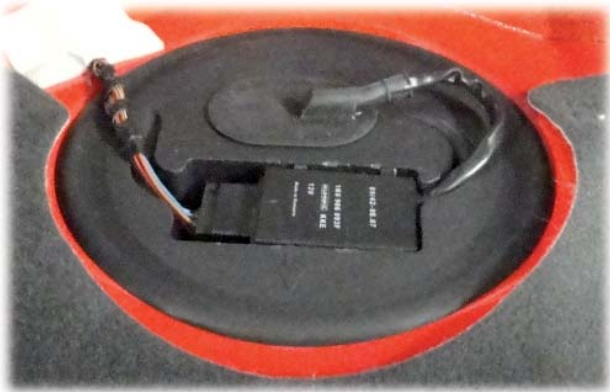
Sistema de combustible regulado en función de las necesidades con unidad de control para bomba de combustible
