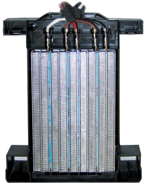
Elemento de calefacción adicional de aire Z35 parcialmente desarmado
