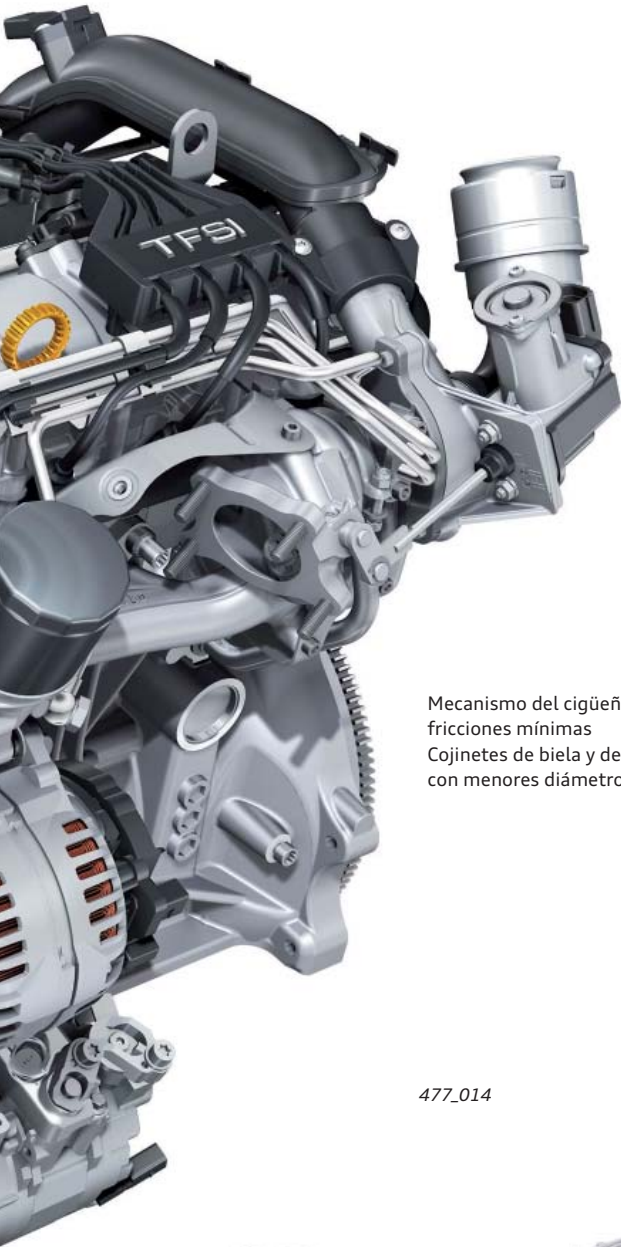
Desaireación del cárter del cigüeñal con separador de aceite, integrada en el bloque y en la culata
