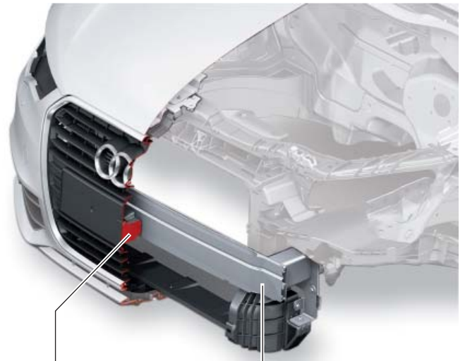
Espuma integral de protección para peatones
