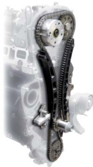
Distribución de cadena exenta de mantenimiento (Longlife)
