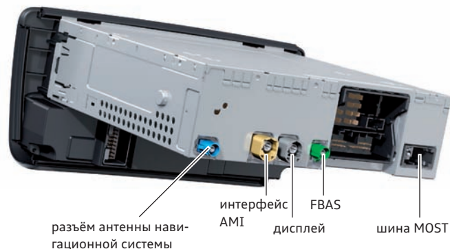
Тыльная сторона блока управления J794 в MMI 477_072
