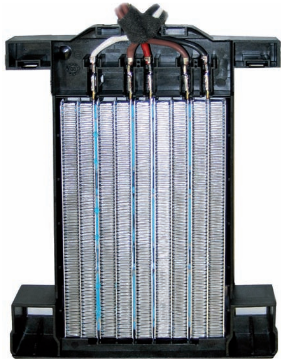
Нагревательный элемент дополнительного воздушного отопителя Z35, в частично разобранном виде
