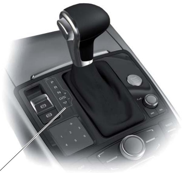
El esquema de cambio de marchas con indicación de marchas está integrado en el marco de diseño de la consola. El visor de posición de la palanca selectora Y26 se monta como componente separado desde abajo.
