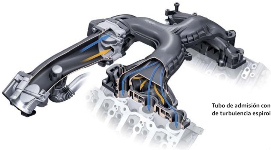
Tubo de admisión con una chapaleta de turbulencia espiroidal
