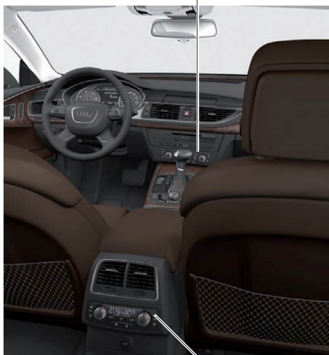
задняя панель управления и индикации климатической установки E265
