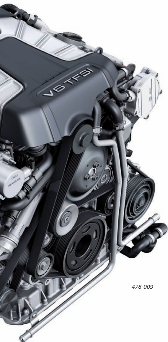
модифицированный ременный привод (без насоса гидроусилителя рулевого управления)
