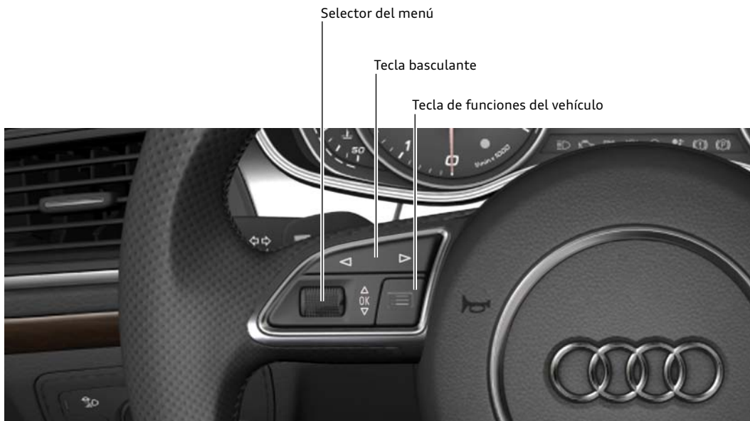
Volante multifuncional con los botones para operar el sistema de información del conductor
