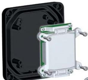
Módulo de potencia 3 para faro LED izquierdo (luz de viraje) A33
