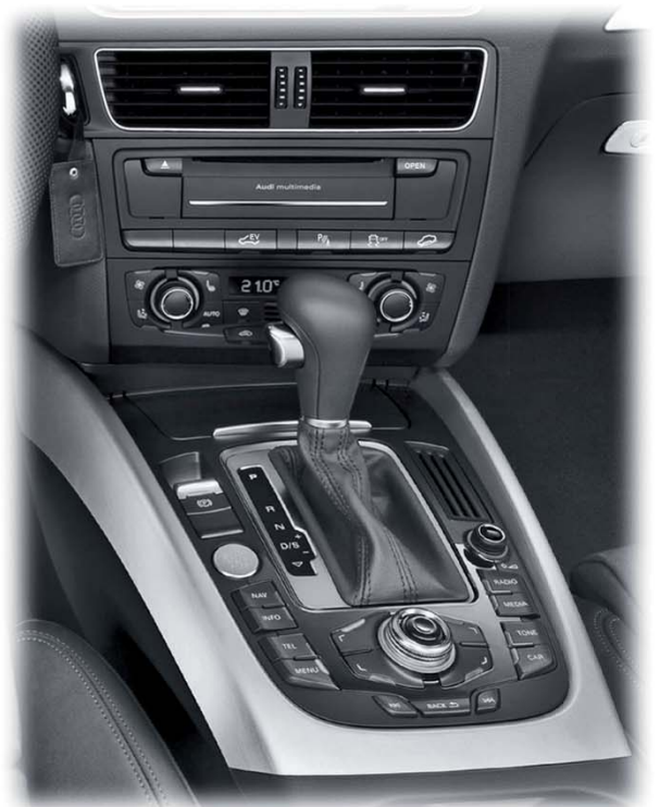
Schalter für EV-Mode und Schaltbetätigung mit tip-S Funktion
