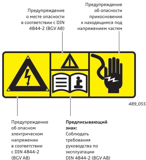
Предупреждающие наклейки с надписью «Danger» (опасность) указывают на высоковольтные компоненты или детали, находящиеся под высоким напряжением.
