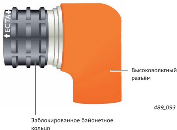
На иллюстрации для примера показан разъём P4 (со стороны провода).
