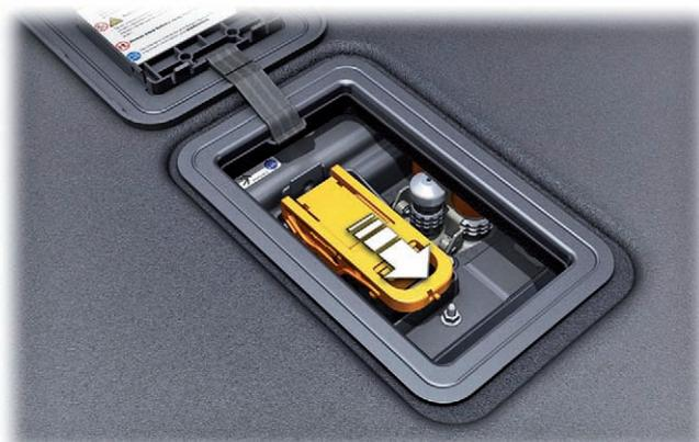
Сервисный разъём в установленном (рабочем) положении
