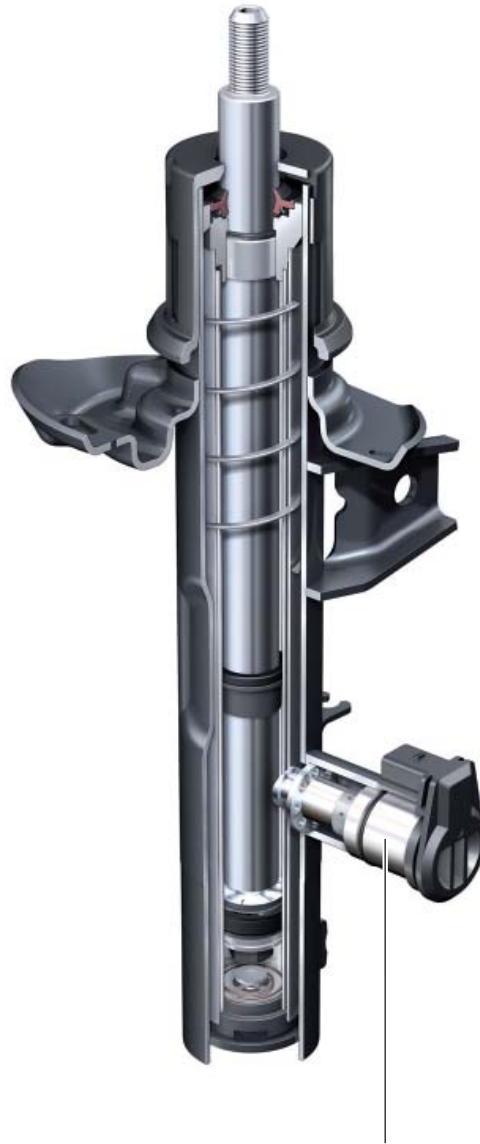
Electroválvula excitable eléctricamente (válvula para reglaje de la amortiguación)
