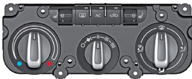
Блок управления климатической установки с ручным управлением J301
