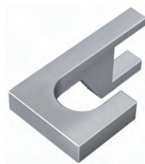
Fijación de la chapaleta Wastegate para trabajos de ajuste en el actuador de la presión de sobrealimentación del turbocompresor (Grupo de equipamiento: A1)
