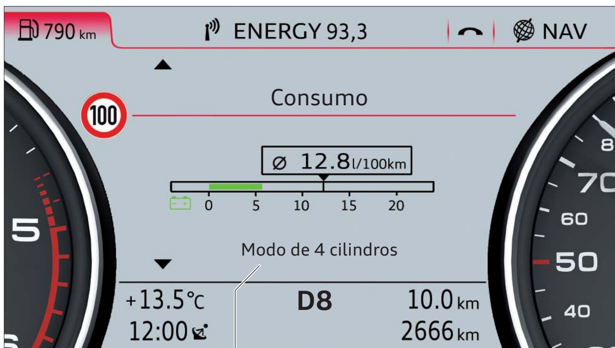
Indicación de la desactivación de los cilindros en el cuadro de instrumentos
