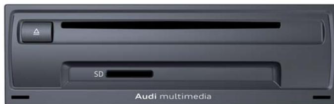
Anverso con MIB Standard, variante de radio (MMI Radio)
