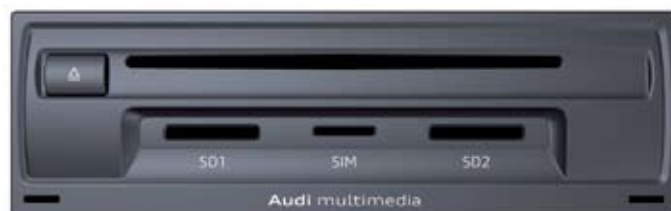
Передняя сторона MIB High с автотелефоном Bluetooth
