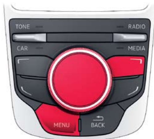
Комбинация клавиш для перезапуска системы
