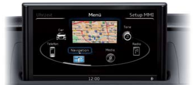
7,0-дюймовый цветной TFT-дисплей для MMI Navigation plus
