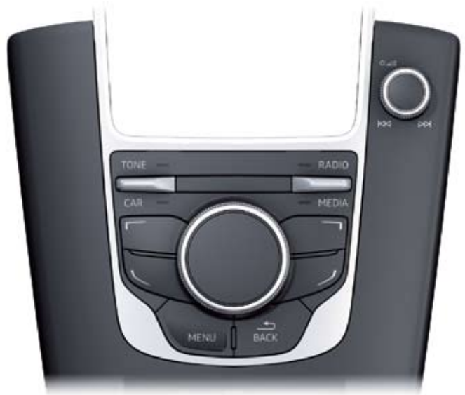
Панель управления с переключателем TONE/CAR
