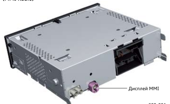
Тыльная сторона MIB Entry plus (MMI Radio)
