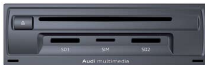
Передняя сторона MIB High с автотелефоном Bluetooth (MMI Navigation plus)
