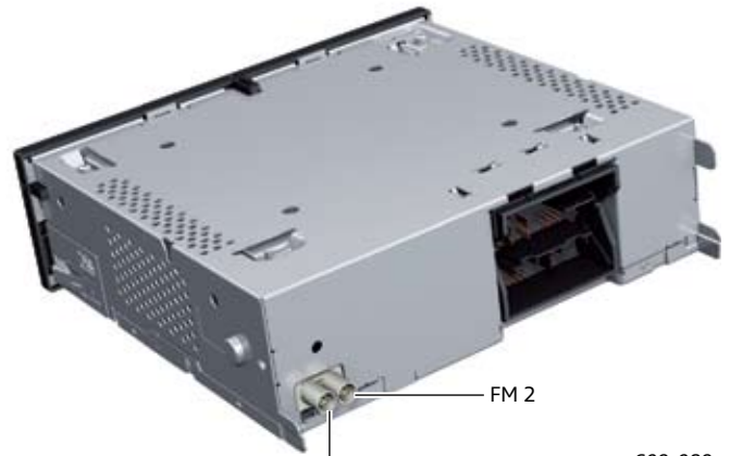
Передняя сторона MIB Entry (Audi Radio)
