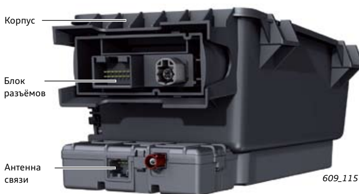
Тыльная сторона отсека Audi Phone Box
