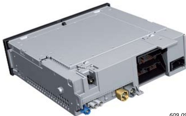
Тыльная сторона MIB High (MMI Navigation plus)
