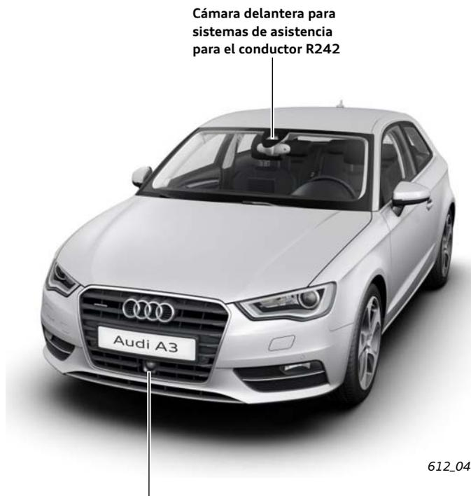
Cámara delantera para sistemas de asistencia para el conductor R242
