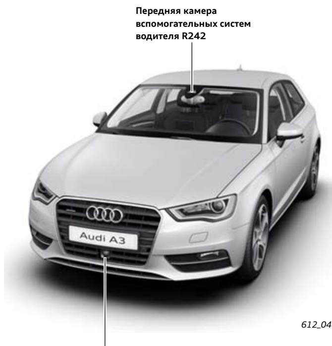
Радарный датчик адаптивного круиз-контроля (датчик адаптивного круиз-контроля G259 и блок управления адаптивного круиз-контроля J428)
