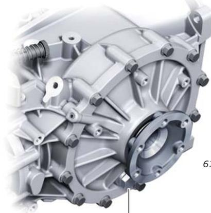
Getriebe mit älterem Baustand haben hier eine Kontrollschraube. **Diese darf nicht zur Ölstandskontrolle verwendet werden!**
