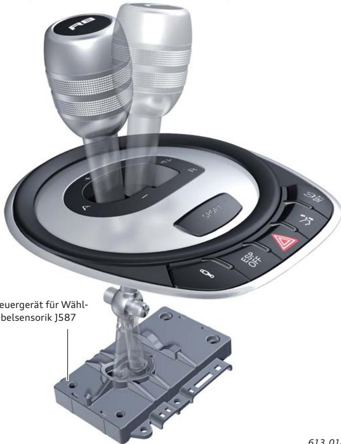
Steuergerät für Wählhebelsensorik J587
