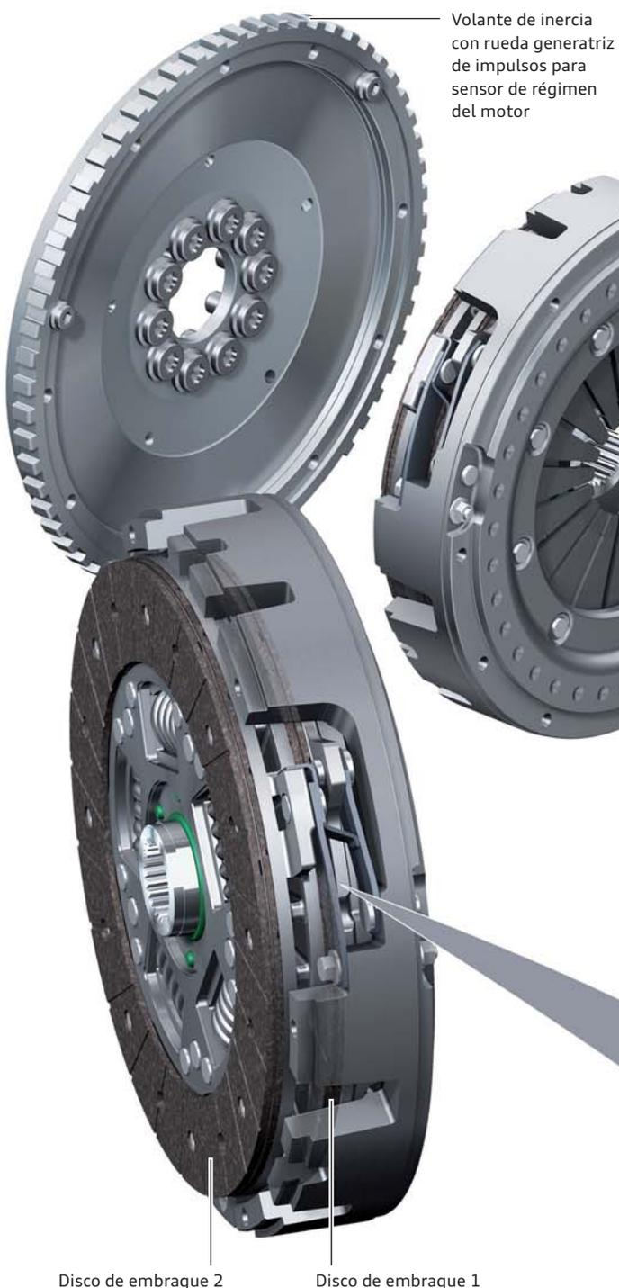
Tanto en el caso del cambio manual como en el del R tronic se transmite el par del motor por medio de un embrague de doble disco. La ventaja de un embrague doble disco reside en su capacidad de transmitir pares intensos y en su durabilidad, teniendo a su vez un diámetro pequeño, si se lo compara. Para mantener lo más reducido posible el espacio necesario para el embrague se renuncia a un plato de presión en versión reajutable.
