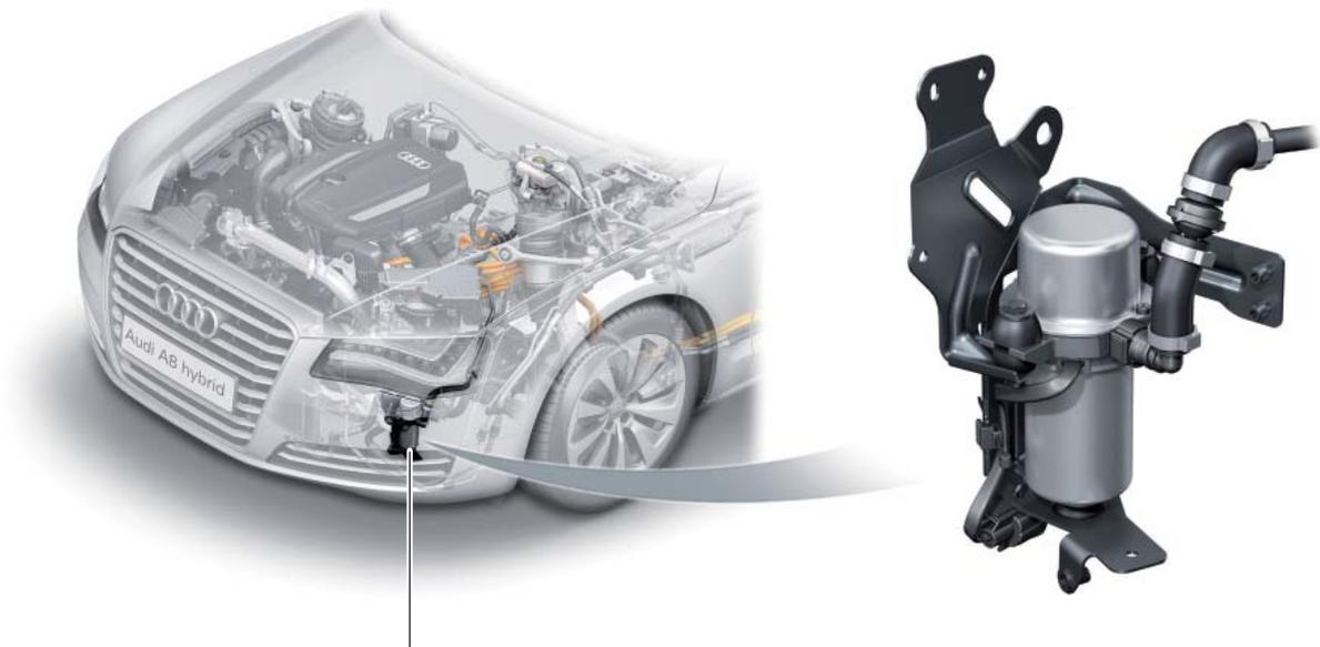
Unterdruckpumpe für Bremskraftverstärker V469
