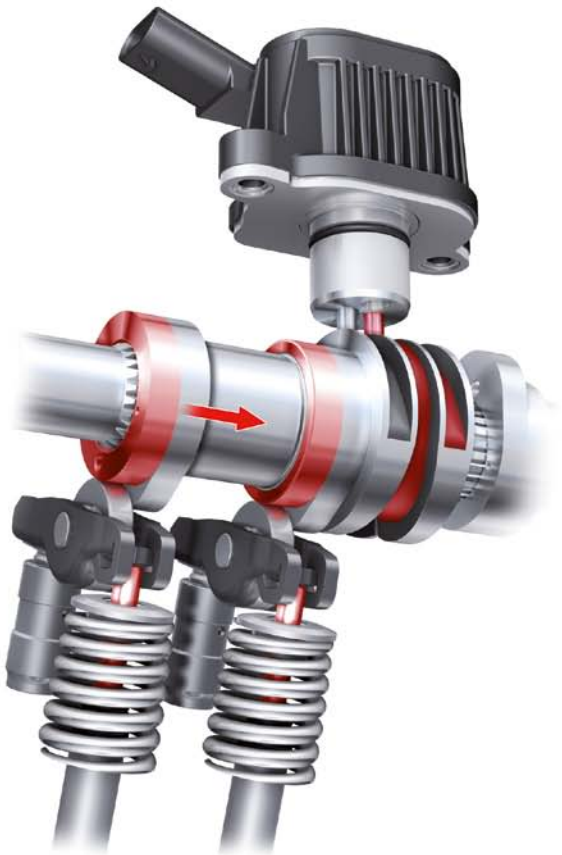
Nockenstück wird zum Nullnocken verschoben 2-Zylinder-Modus
