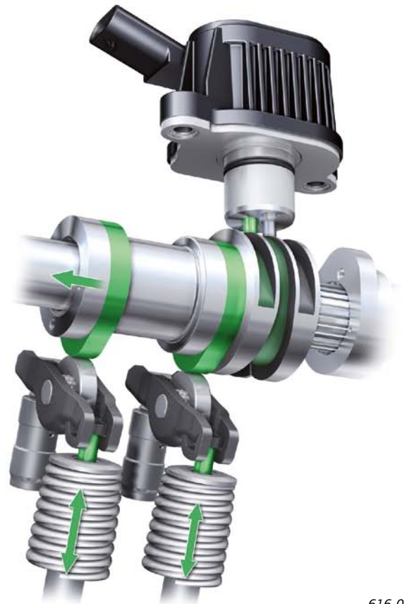
Nockenstück wird zurück zum Arbeitsnocken verschoben 4-Zylinder-Modus
