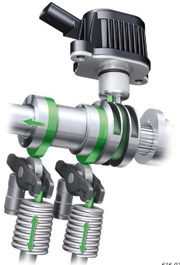
Elemento portalevas desplazado de vuelta (leva de trabajo) Modo de 4 cilindros
