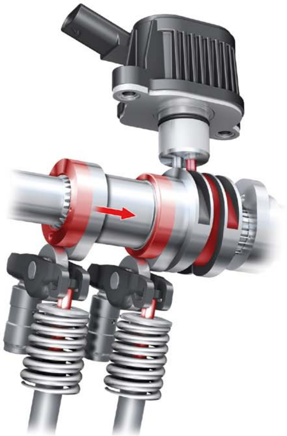
Elemento portalevas desplazado (leva cero) Modo de 2 cilindros
