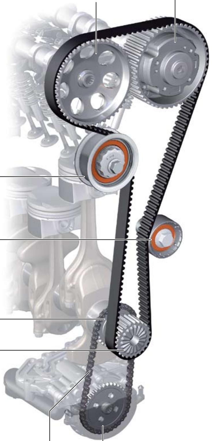
Зубчатая цепь привода масляного насоса (только 1,4 л TFSI)
