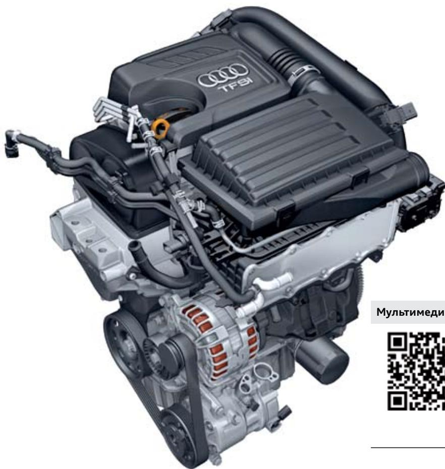
Двигатели серии EA211 являются полностью новой разработкой, неизменным по сравнению с предшественниками (серия EA111) осталось только расстояние между осями цилиндров — 82 мм. Новое положение двигателя в моторном отсеке (с наклоном 12°) позволило унифицировать соединение с коробкой передач, положение приводных валов и габаритную длину коробки передач. За счёт этого число различных комбинаций двигатель-коробка передач в рамках платформы концерна MQB уменьшилось почти на 90 %.
