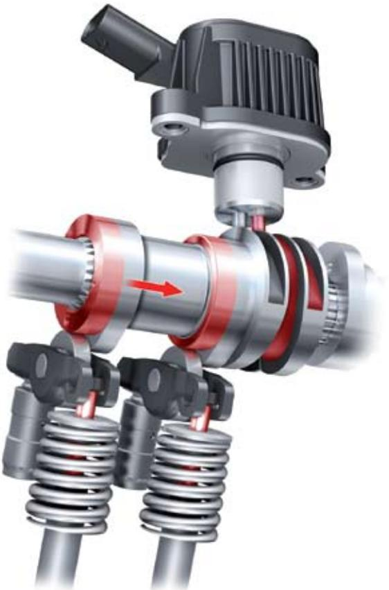
Блок кулачков сдвигается в положение «нулевых» кулачков 2-цилиндровый режим
