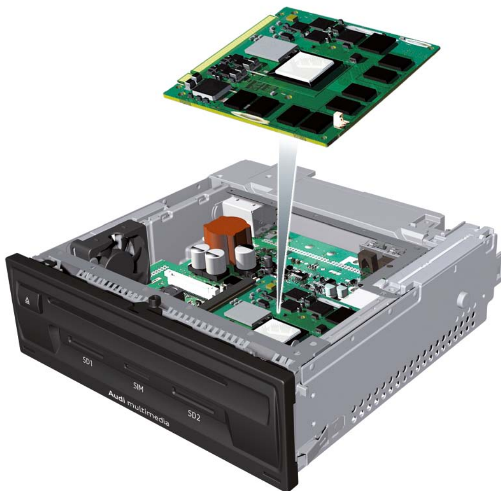
Schematische Darstellung MMX-Board
